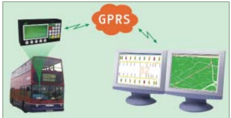
> Die komplette Kommunikation zwischen Zentrale und Fahrzeug wird über den öffentlichen Mobilfunkstandard GPRS (General Packet Radio Service) abgewickelt.
