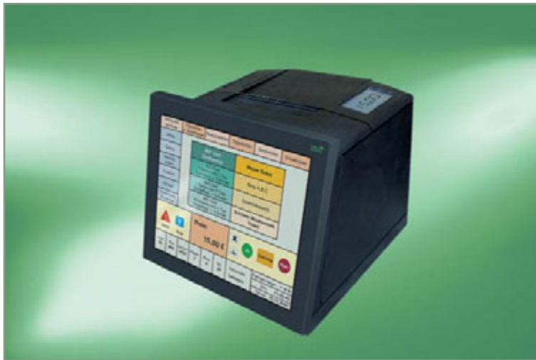
> EVENDpc vereint die Leistungsmerkmale der modernsten INIT-Bordrechner-Generation mit Zahlungsgeräte-Funktionen.
