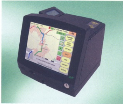
EVENDpc: Der PC-basierte Fahrscheindrucker kommt in über 3 000 Fahrzeugen der DB Stadtverkehr Bayern zum Einsatz (Bild: INIT).
