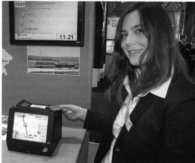
Bild 40: Am über 70 Tarife kennenden „EVENDpc“ von INIT ist im Projektgebiet Bayern das Bezahlen mit bereits vorhandenen RFID-Karten möglich; dem Fahrer wird auf Wunsch die Strecke wie in einem Navigationssystem angezeigt
